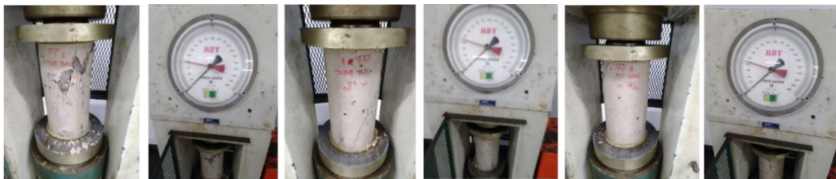
(b). Dokumentasi hasil pengujian spesiemen pengecoran Pelat Barat
