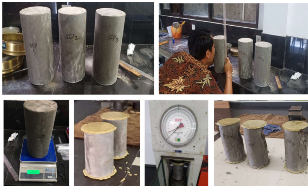
Gambar 1. Proses pengujian spesimen hasil pncampuran percobaan (trial mix)
