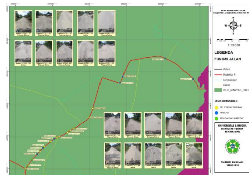
Gambar 4. Peta Kerusakan Jalan Kolektor A Kecamatan Manyak Payed
