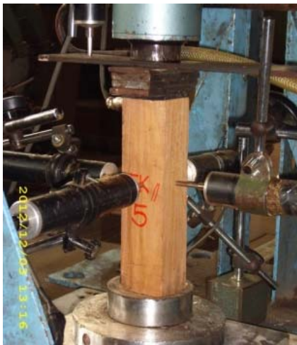
Gambar 3. Pengujian kuat tarik sejajar serat Pengujian kuat tekan tegak lurus dan sejajar terhadap serat kayu sebagaimana yang disajikan pada Gambar 2 dan 3 (berdasarkan standar ASTM D143-2002) dilakukan dengan kecepatan pembebanan sebesar 0,6 mm/menit.
