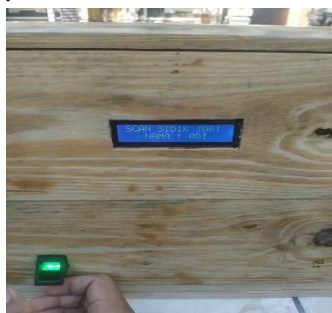
Gambar 4.23 Pengujian sensor fingerprint Yang Ter-validasi
