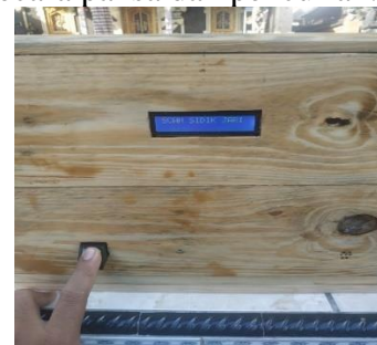
Gambar 4.24 Pengujian Menggunakan jari Yang Tidak Ter-validasi
