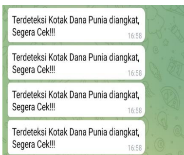
Gambar 4.26 Hasil Pengujian Aplikasi Telegram Saat Magnet Dijauhkan dengan kutub pasangannya.
