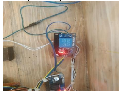
Gambar 4.27 Hasil Pengujian Relay Saat jari Yang Ter-validasi Didekatkan Pada sensor Fingerprint.
