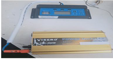
Gambar 2.6. Model inverter yang digunakan dalam PLTS
