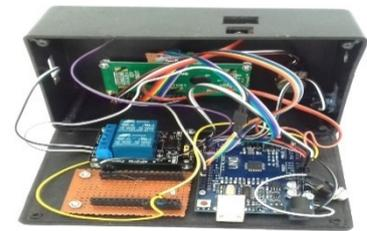
Gambar 4.8 Pemasangan Relay
