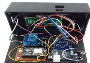
Gambar 4.9 Pemasangan *Module Wireless*
