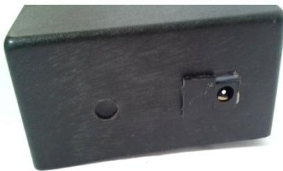
Gambar 4.1 Pemasangan *Shocket 9 Volt*
