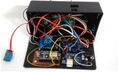
Gambar 4.10 Pemasangan *DHT11 Indoor*
