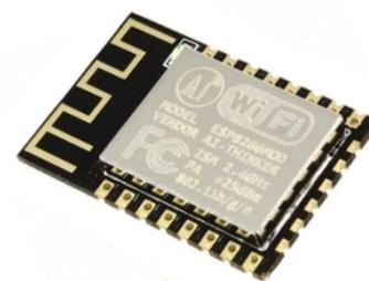
Gambar 2. Modul ESP8266
