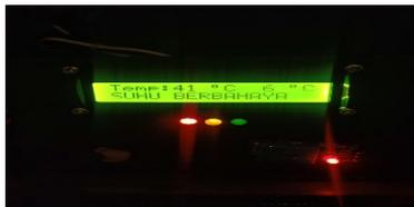
Gambar 4. 17 Pengujian Sensor Suhu Outdoor Kondisi Berbahaya
