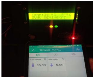
Gambar 4. 16 Pengujian Sensor Suhu Outdoor Kondisi Meningkat.
