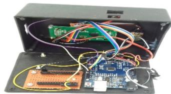
Gambar 4. 7 Pemasangan *Board Arduino*
