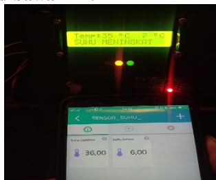
Gambar 4. 16 Pengujian Sensor Suhu Outdoor Kondisi Meningkat.
