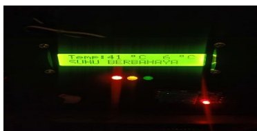
Gambar 4. 17 Pengujian Sensor Suhu Outdoor Kondisi Berbahaya
