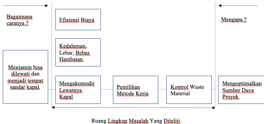
Gambar 5 . F.A.S.T Diagram Pekerjaan Pengerukan
